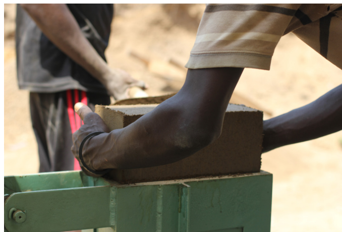
Producering af mursten på stedet
